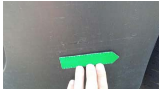
Arañazos perceptibles al pasar la uña o con una superficie \leq 45 \text{ cm}^2 (como una tarjeta de crédito)
