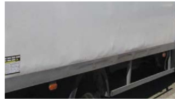
Paneles laterales de fibra: Deformación en la parte inferior, longitud > 1 m Nota: La sustitución del panel frontal de la carrocería inferior requiere el desmontaje de los bajos de la carrocería.
