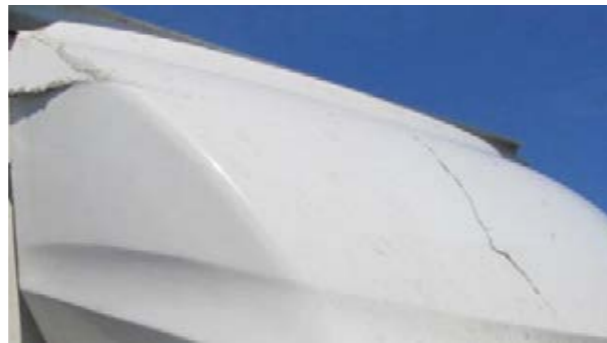
Cabover y deflector: Grieta grande, falta pieza o no merece la pena de repararse
