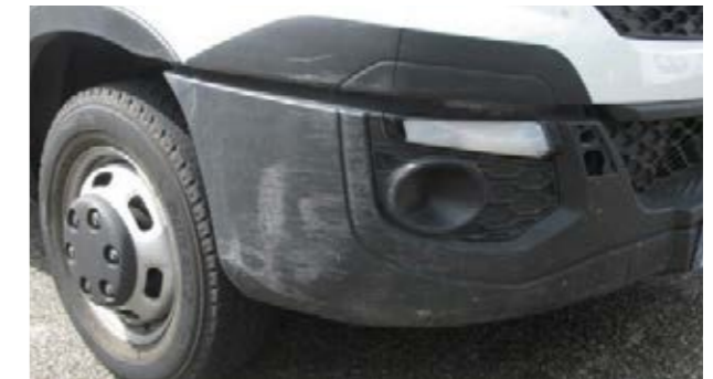
Levantamiento de material o deformación reparable y económica
