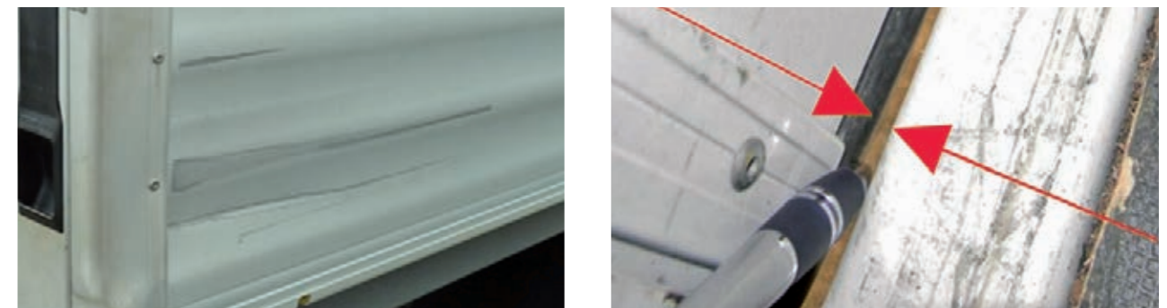
Deformación en los conductos que no merece la pena de reparar, no se puede efectuar el cierre o no es a prueba de arena
