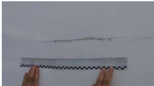
Paneles laterales: Arañazo con levantamiento de material \geq 20 cm merece la pena de reparar. Opción para pintar medio panel
