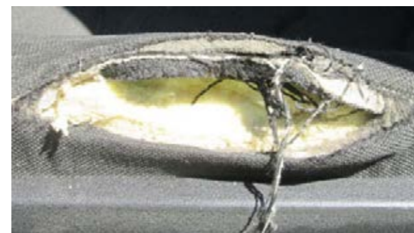
Falta espuma o el marco está roto
