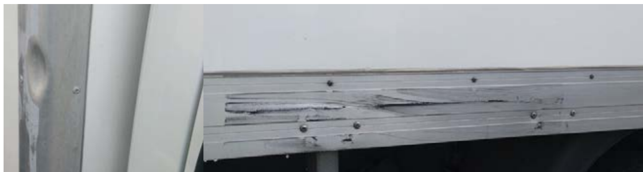
Perfiles laterales de los bajos de la carrocería: Deformaciones que merecen la pena de reparar
