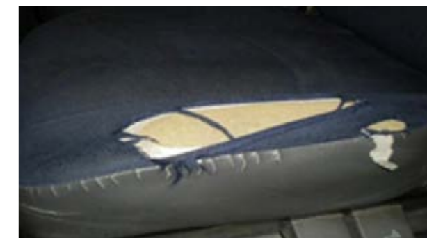
Quemadura > 3 mm, revestimiento perforado o roto, sin deterioro de la espuma
