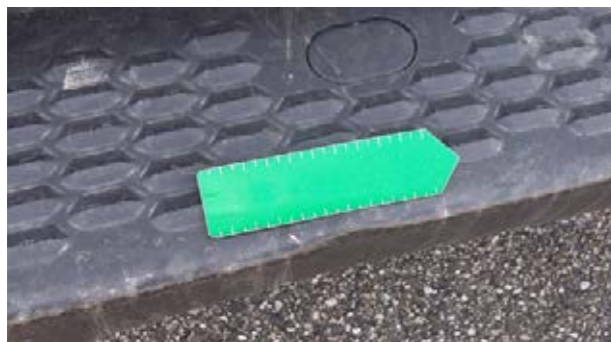
Estribos traseros: Ligera deformación
