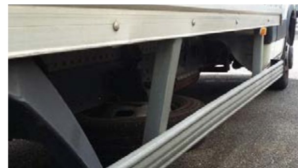
Portabicicletas: Deformación que merece la pena de reparar
