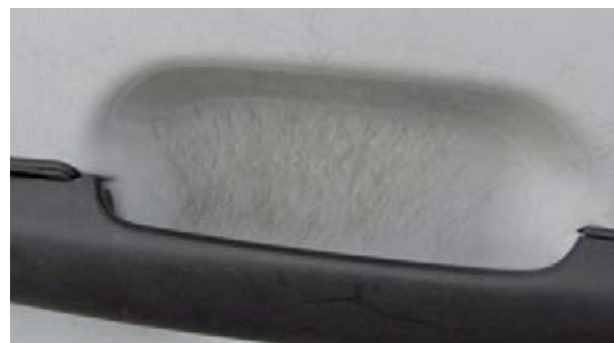
Arañazos superficiales ligeros, p.ej., en el tapón del depósito de combustible, las trampillas, manillas de las puertas, parachoques y revestimientos
