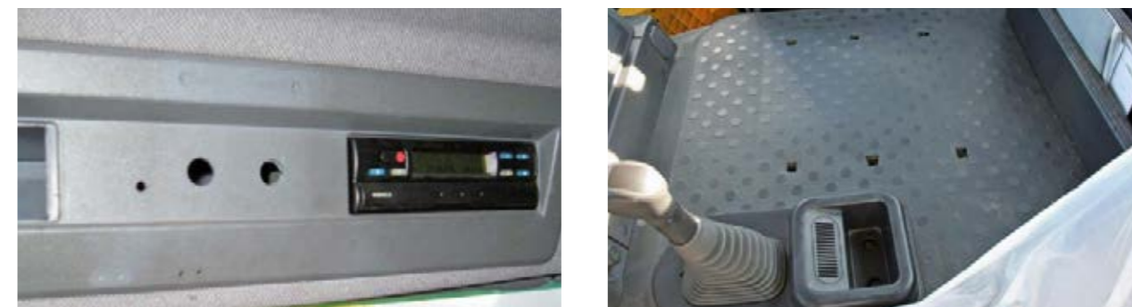
🔧 Faltan elementos de mando, del asiento o de revestimiento o están rotos o agujereados
