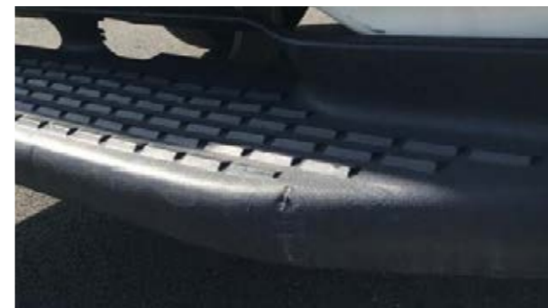
Estribos traseros: Deformaciones que merecen la pena de reparar
