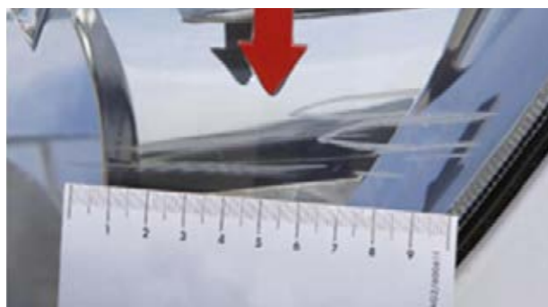
Fuertes arañazos (con levantamiento de material), fuera del campo de iluminación y del faro estanco
