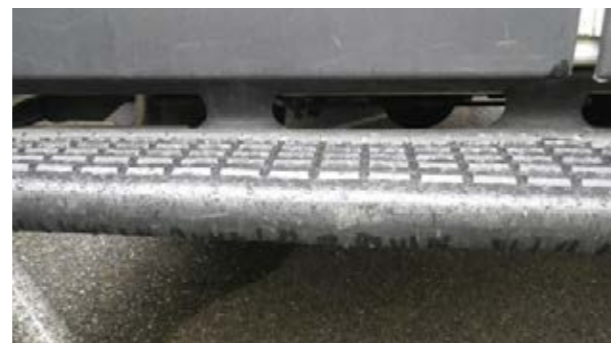
Pequeños arañazos en la pintura de los bordes de la zona de carga
